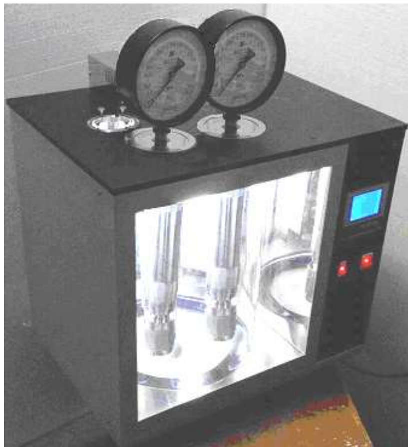
Рис. 4 Универсальный термостат с 2 бомбами Рейда БР-ПХП
