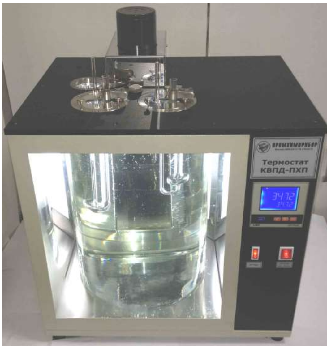
Рис. 2 Универсальный термостат с 2 капиллярными вискозиметрами В крышке термостата расположены четыре отверстия: 2 отверстия \text{Ø}68\text{мм} - унифицированные места для установки капиллярных вискозиметров, цилиндров для ареометров или бомб Рейда; 1 отверстие \text{Ø}58\text{мм} - технологическое отверстие для залива теплоносителя и установки погружного ТЭНа компрессора охлаждения, приобретаемого дополнительно; 1 отверстие \text{Ø}5\text{мм} - дополнительное отверстие с цанговым зажимом контрольного термометра для контроля температурной погрешности, приобретаемых дополнительно к универсальному термостату.
