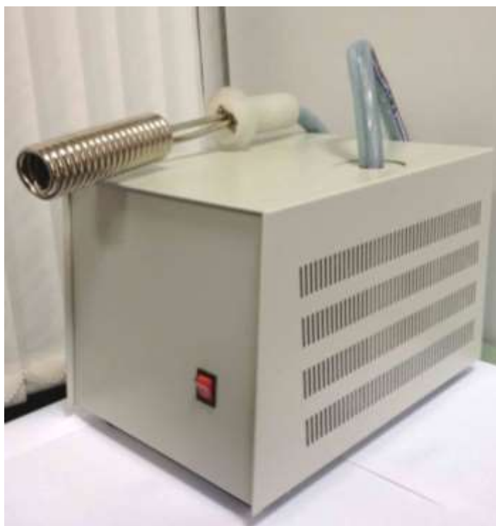
Рис. 7. Компрессор охлаждения с погружным ТЭНом КО-ПХП
